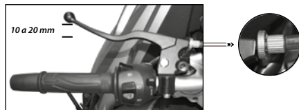
A B Imagen 21. Ajuste de la palanca del embrague.
