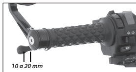
Imagen 20. Ajuste de la palanca del embrague.
