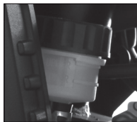
Imagen 28. Completar el nivel del líquido del freno trasero.
