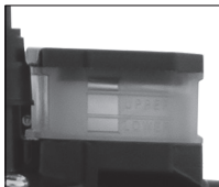
Imagen 25. Nivel del líquido del freno delantero.
