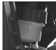
Imagen 26. Nivel del líquido del freno trasero.
